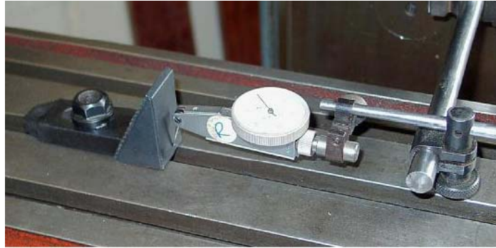
그림 5.13 영점 위치 조절을 위한 과정
