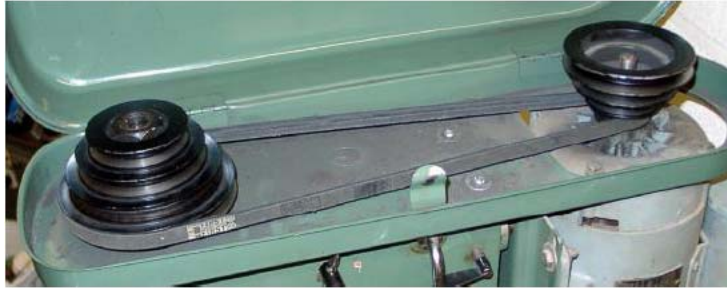
그림 5.15 풀리(pully) 스피들 드라이브
