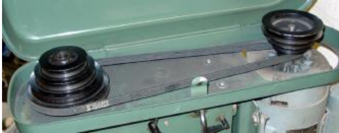
图 5.15 – 主轴滑轮驱动
