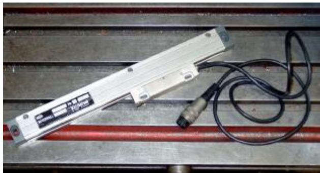
图 4.15 – 玻璃刻度编码器（待安装）
