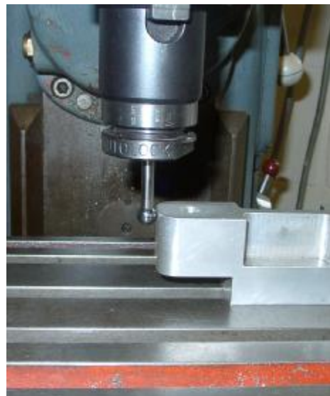
图 7.12 –在铣床上使用寻边器
