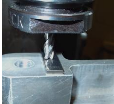
图 7.10 –在铣床中使用量块设定 Z 轴偏移量
