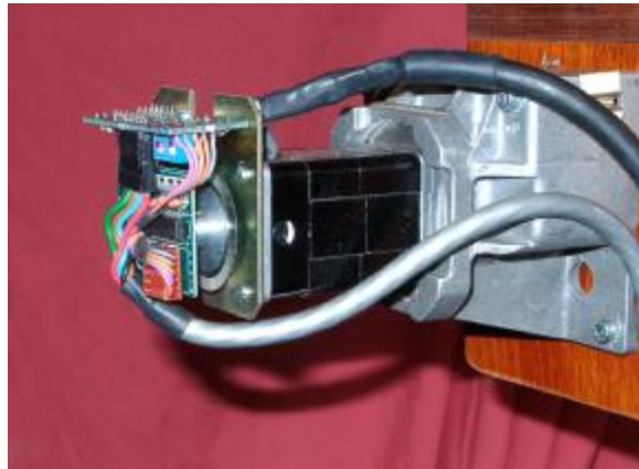
Figure 4.3 – 小型直流伺服电机（带编码器和齿轮箱）
