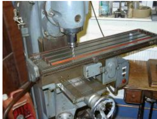
图 4.10 – 刀具坐标为 X=0、Y=0 位置的铣床
