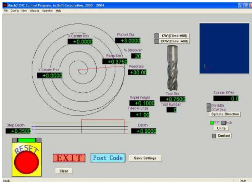
**Figura 3.8 Aplanado Circular con valores por defecto**
